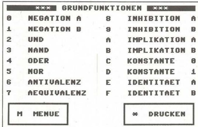
Bild 2. Alle 16 möglichen logischen Gatterschaltungen bei Digitalgliedern mit bis zu zwei Eingängen
